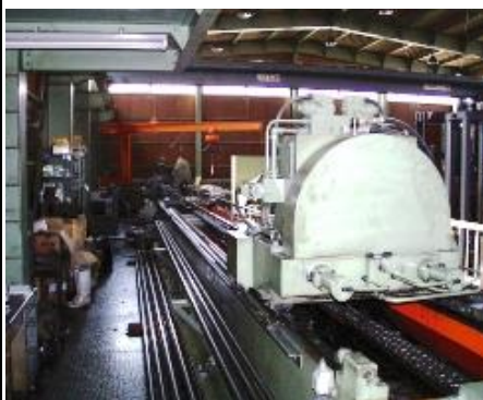
横型二軸同時加工式 最長 7m ストローク 加工径 50~180mm 主に量産品向き
