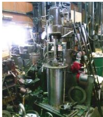
手動式拡張固定ホーニング機 幅広い径、形状に対応 精密加工向き
